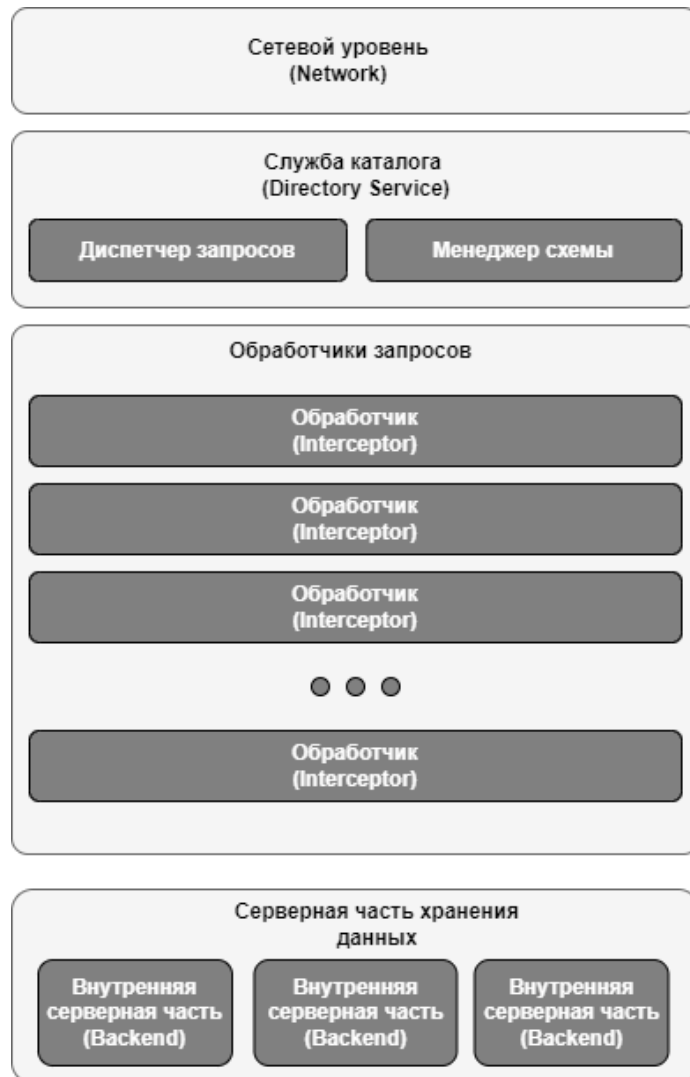
Функциональная схема Системы управления объектами каталога «Селенга» Рисунок 2
